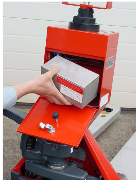
Batterie démontable en zone dangereuse
